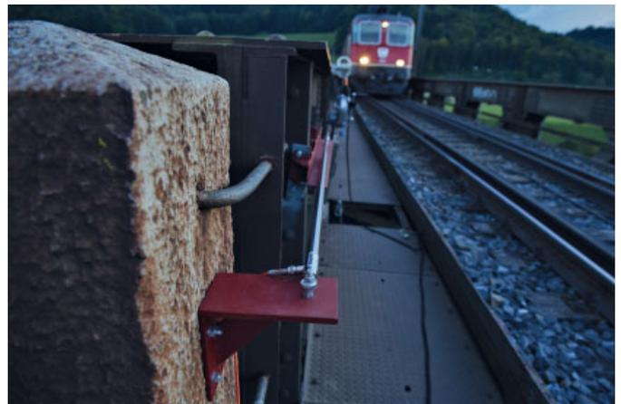
Bild 5. Am Widerlager Hüntwangen installierter Wegmessgeber
