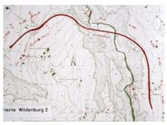
21 Varianten der Linienführung für die neue Lorzentobelbrücke: Die Variante «Wildenburg 2» wurde als Bestvariante festgelegt (Nr. 13 im Plan und Abb. nebenan links). Zwischen der südlichsten Variante 21 (Allenwinden) und der nördlichsten Variante 1 (Wulfligen, Abb. ganz links) – wurden über die gesamte Breite alle denkbaren Trassierungen untersucht. Dieses umfassende Variantenstudium gewährleistet ine zuverlässige Gesamtbeurteilung der gegebenen Situation.
